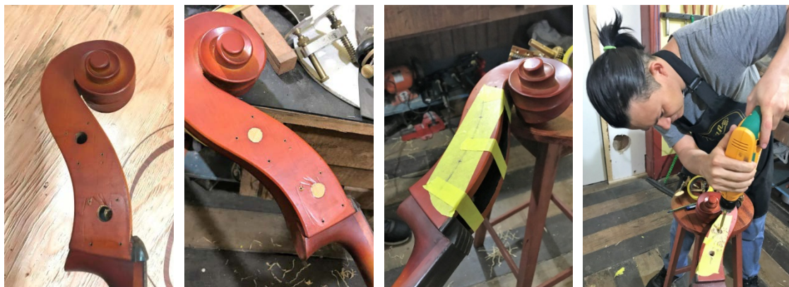
Figuras 41 a 44: fechando os furos antigos e abrindo os novos para receber as cravelhas
