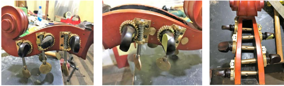
Figuras 46 a 48: instalação das cravelhas novas
