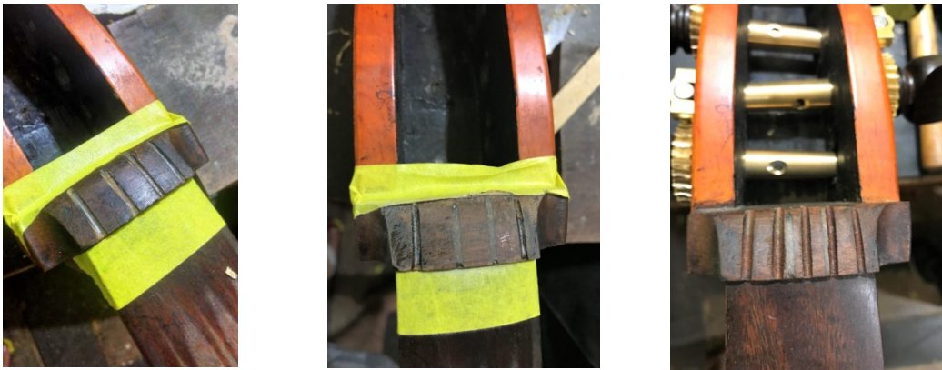
Figuras 49 a 51: vedação das fendas antigas e reabertura das cinco novas fendas
